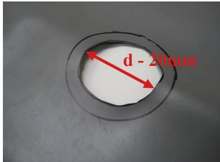
Erhitzen Sie den Flansch rund um den Ausschnitt und ziehen Sie ihn direkt über das Rohr. Es entsteht ein etwa 20 mm hoher Schweißrand. Drücken Sie den Flansch bis hinunter auf die Grundplatte.
