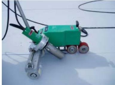
Der Zuluftfilter des Schweißgerätes muß sauber und staubfrei sein. Falls nötig, Filter mit Pinsel oder Druckluft reinigen.
