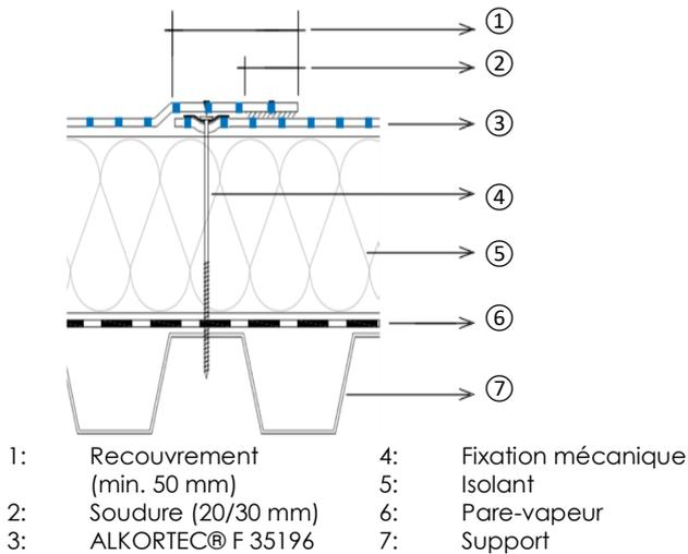
**Fig. 3 – Recouvrement des lés (système d'étanchéité fixé mécaniquement)**
