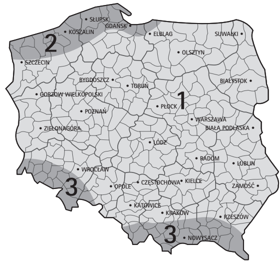
Rys. 1: Podział Polski na strefy obciążenia wiatrem
