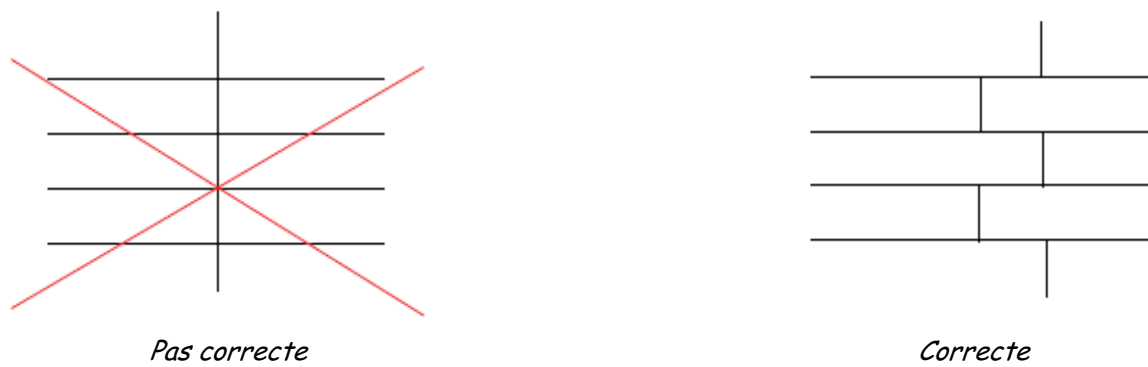
Figure 2 - Dispositions relatives à la soudure des lès
