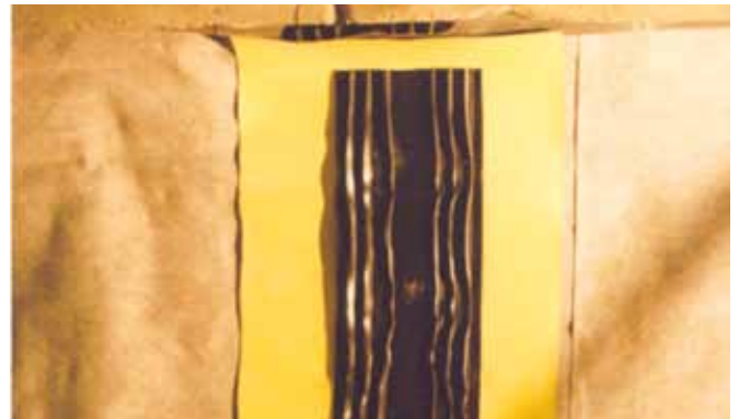
Préfabrication de Géomembranes soudées avec des Water Stops
