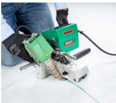
Assemblage par soudure thermique.
