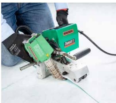
Assemblage par soudure thermique.
