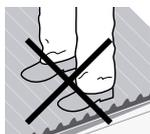
La mise en œuvre des plaques **RENOLIT ONDEX** impose le respect des règles de sécurité applicables pour l'accès et la circulation sur les couvertures en matériaux légers (article R45 34-88 du code du travail).
