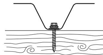
Couturage conseillé pour un entraxe > 80 cm avec un plasticulture expansif en néoprène à positionner en milieu de recouvrement longitudinal
