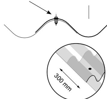
Recouvrement de 300 mm
