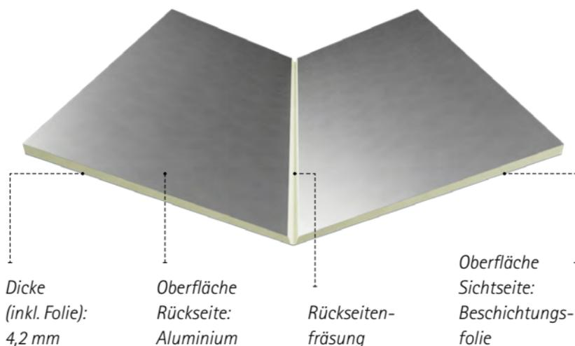
Die Bearbeitung der hochwertigen Verkleidungsplatte ist denkbar einfach: Auf der Rückseite der Platte eine kleine Nut einfräsen, und schon können Sie RENOLIT BENDIT exakt in den Winkel kanten, den Sie brauchen. Bis zu 90 Grad geht alles. Die Kantung sitzt genau an der gewünschten Stelle, und die schöne Oberfläche macht das alles mit.
